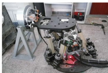
图1 多信息融合印刷机精密装配机器人
